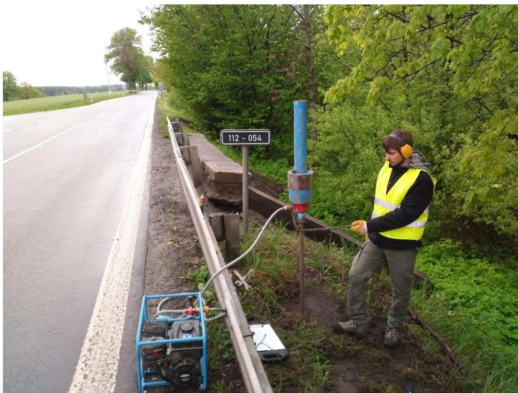
Obr. 2: Realizace těžké dynamické penetrace DPH1
